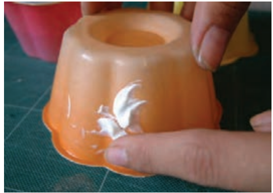
۱- زدن ماده جداکننده به مدل
