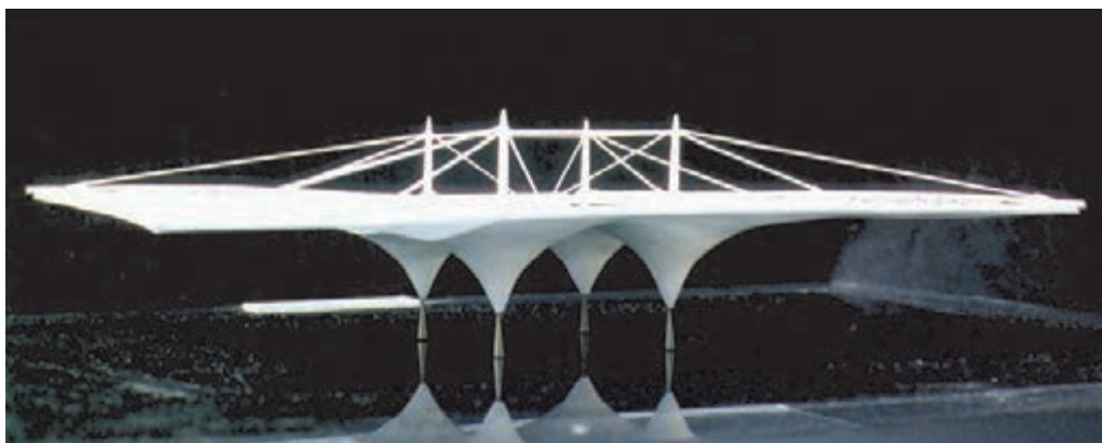
شکل ۳۲- مدل پوسته‌ای با فایبرگلاس
