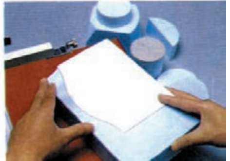
۲- مونتاژ قطعات فومی ساخته شده
