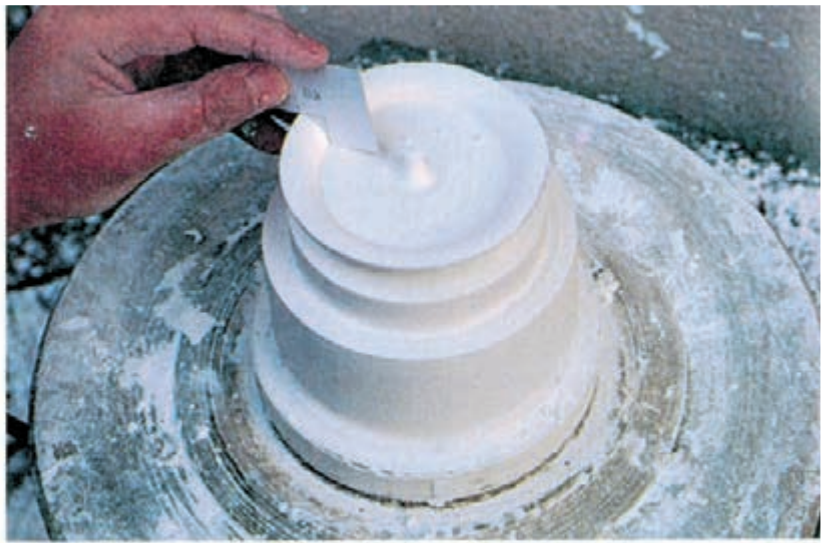
۱۵- ایجاد انحنا - میزان انحنا لبه کار با شابلون بررسی می شود.
