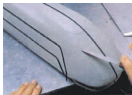
۷- با استفاده از زهوار خطوط اصلی روی مدل اجرا می‌گردد.
