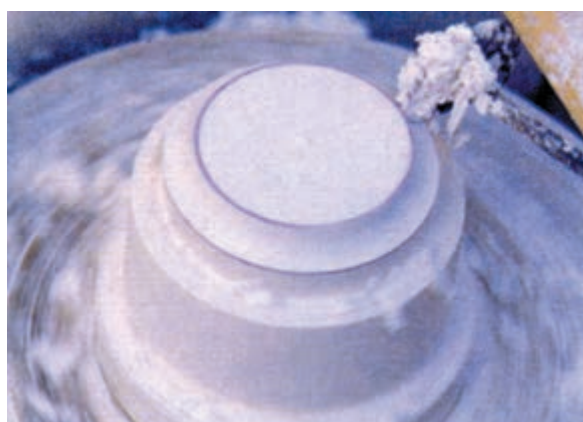
۱۱- ساخت یک پایه برای ایجاد یک مدل روی آن و آغاز مرحله سوم
