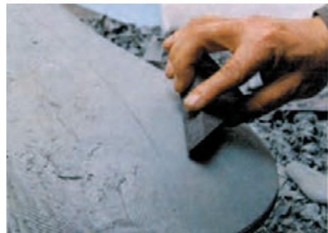
۴- سطح مدل را با یک لیسه پلاستیکی نرم صاف کنید.
