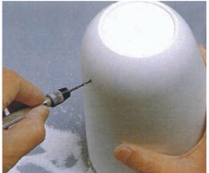
۲۰- ایجاد سوراخ و بین گذاری برای اتصال قطعه الحاقی (مرحله چهارم - مونتاژ)
