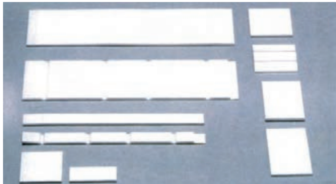
۱- قطعات بریده و زاویه خورده استایروفوم
