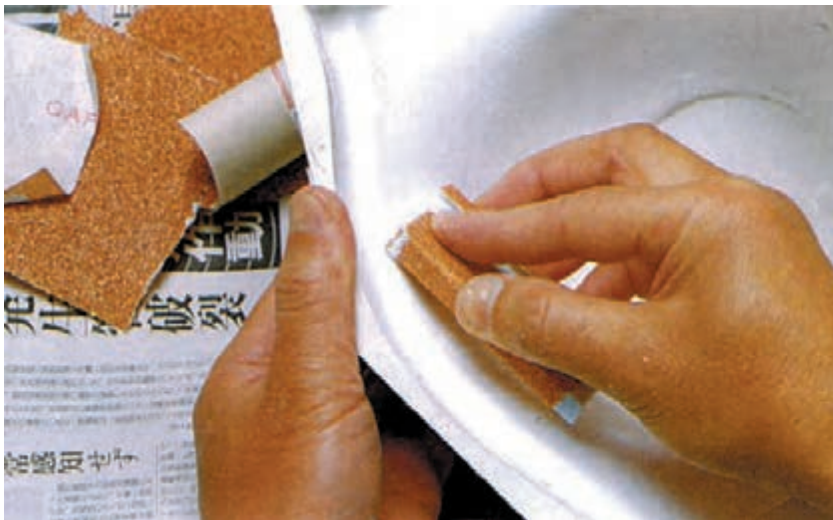
۱۳- زیربهای سطح قالب گچی را پس از خشک شدن گچ با سنباده برطرف کنید.
