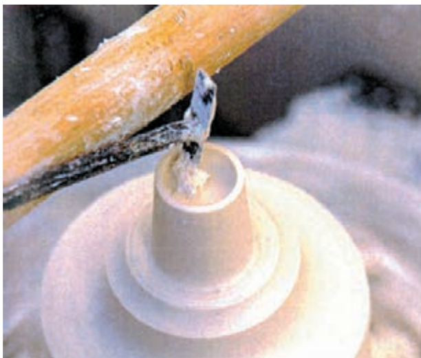
۸- تراش داخلی با استفاده از تکیه‌گاه
