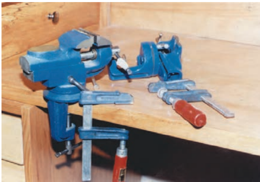
شکل ۳۷- انواعی از گیره‌های بزرگ ماکت‌سازی - گیره رومیزی و پیچ دستی
