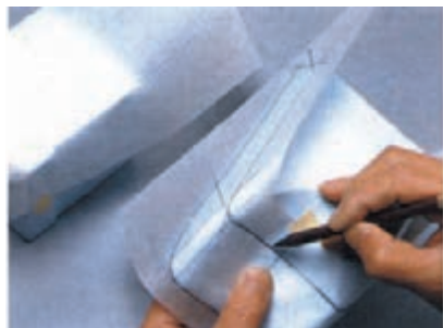
۳- برای به دست آوردن انحنای، یک کاغذ ترسیم (کالک) روی قسمتهای منحنی شابلون بلوفومی گذارده می‌شود و خطوط انحنای برای رسم گسترده مدل پلاستیکی ترسیم می‌گردد.
