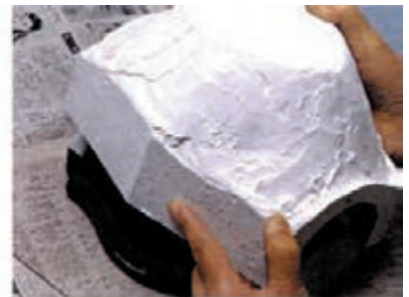
۱۲- پس از خشک شدن قالب گچی، آن را با اندکی حرکت دادن از روی مدل بردارید.
